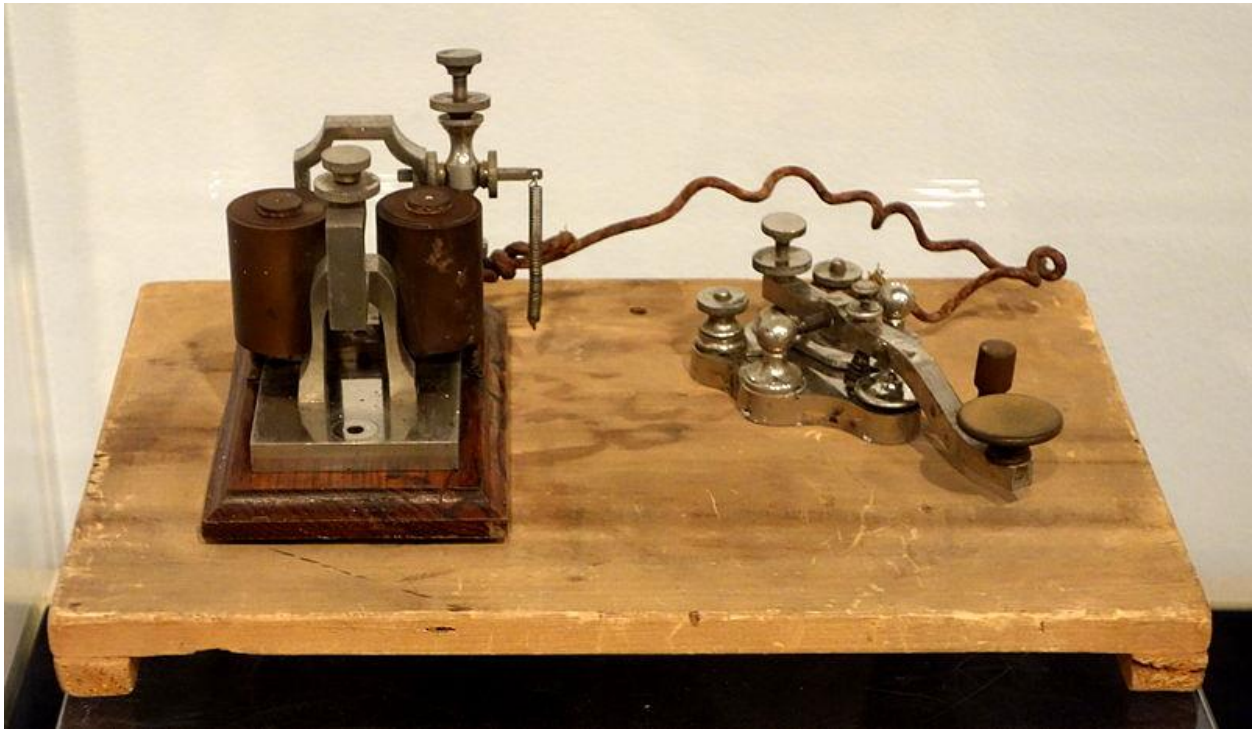
Chave telegráfica e sonda da Western Electric Manufacturing de 1876 - Museu Histórico de Wisconsin – Imagem por Daderot. Domínio Público
